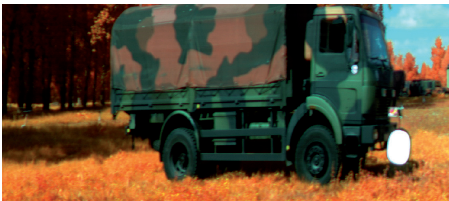
Joonis 10. Infrapunadiapaseoni kunstlike värvide demonstratsioon. Kaitseväge veoki MB 1017 fotokujutis naturaalses värvides (sinine 460 nm, roheline 550 nm, punane 640 nm) ülal ja all sama veok kunstlikes värvides, kus kokkuleppeline punane on nihutatud 800 nm kohale. Nii on otseselt jälgitav loodusfooni 700 nm astme väga tugev ilmnenine kunstliku punase värvi kujul.
